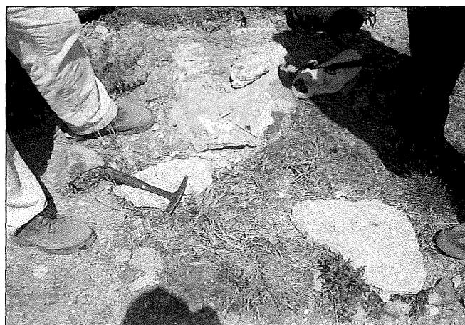
FIGURA 1. Bloque calizo de travertino de 40 Kg extraído de una calicata y muestra fresca.
