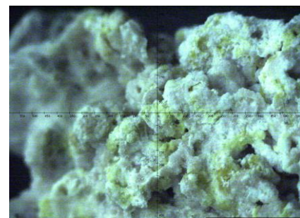
fig 3. Muestra C2 de coquimbita (en blanco) y romboclasa (en amarillo) y zona donde se hace el estudio por \mu DRX.
