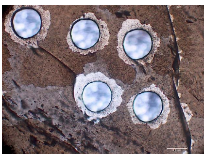
fig 3. Microfotografía de los cráteres de ca. 100 µm (barra de escala) de diámetro correspondientes al análisis de fluorofosfatos de Fe-Mn de Folgosinho.
