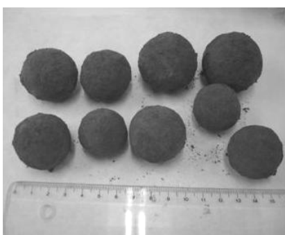
fig 3. Agregados de ceniza volante carbonatada después de la reacción con CO 2 en el reactor rotatorio de 5 L.
