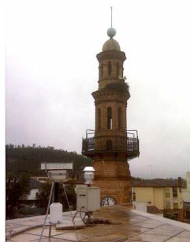
Fig. 1. Captador alto volumen en la estación de muestreo.
