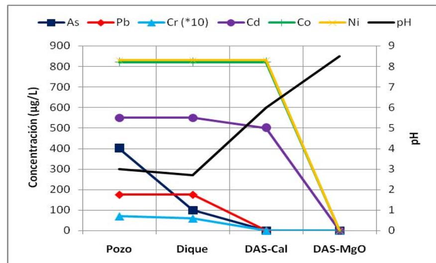
Fig. 2. Evolución de la concentración metálica en los diferentes puntos del sistema de tratamiento para elementos minoritarios. Muestreo realizado en Agosto de 2009.
