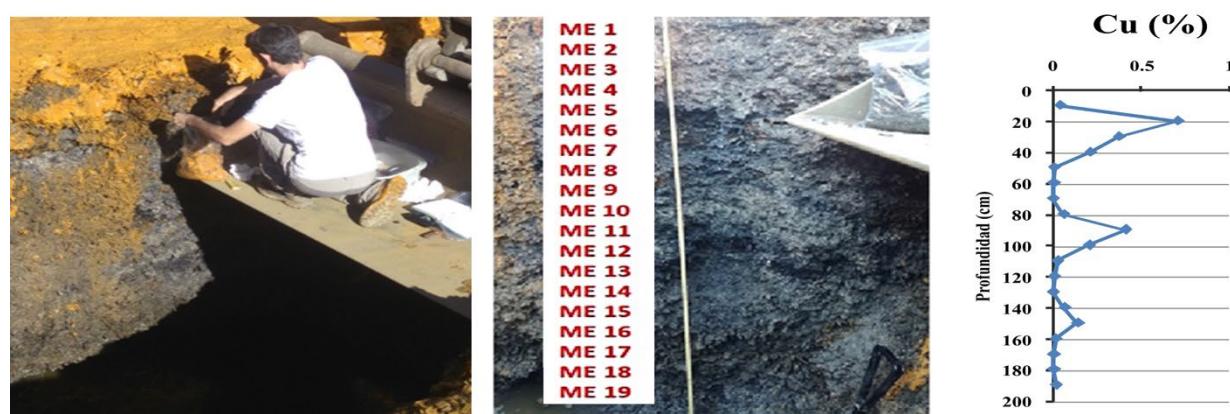
Fig 1. Detalle de la calicata realizada en el primer tanque, la toma de muestras, y la distribución de cobre a lo largo del perfil.
