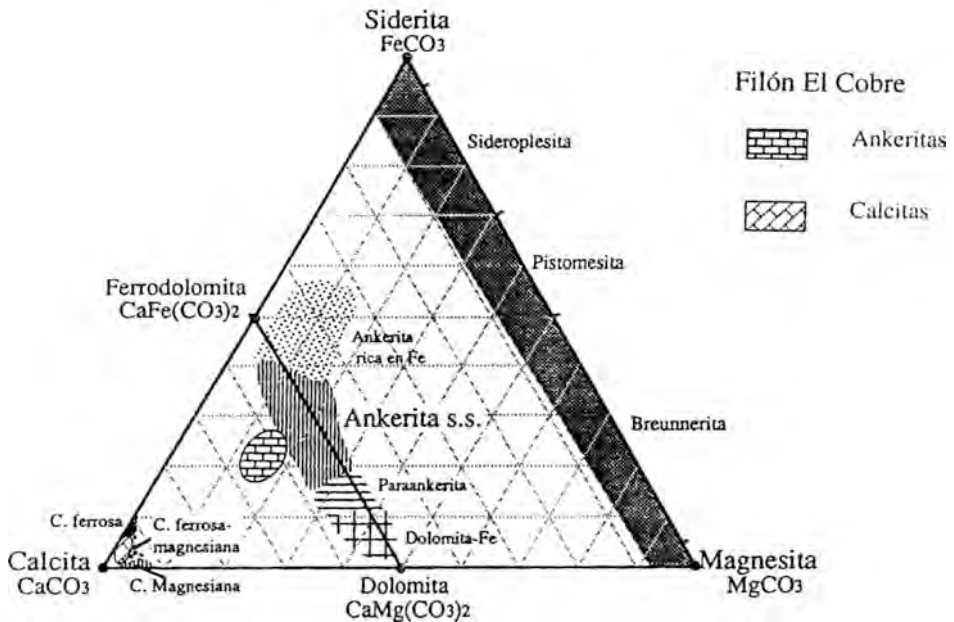
Figura 5.- Representación en el diagrama triangular CaO-FeO-MgO de calcitas (cuadrícula) y ankeritas (mosaico) del Filón El Cobre ( triángulo tomado de Gil, 1991).
