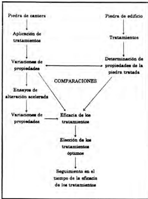
Fig. 1. Esquema metodológico de la valoración de la eficacia de tratamientos de conservación.
