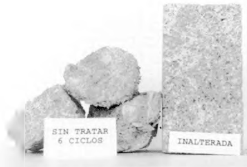
Fig. 6. Probeta de caliza sin tratamiento, sometida a 6 ciclos de cristalización de sales, y probeta de referencia
