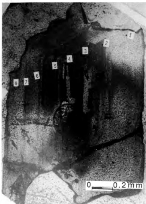
Figura 6. Microfotografía de casiterita zonada. Los números señalan los puntos analizados con la microsonda.
