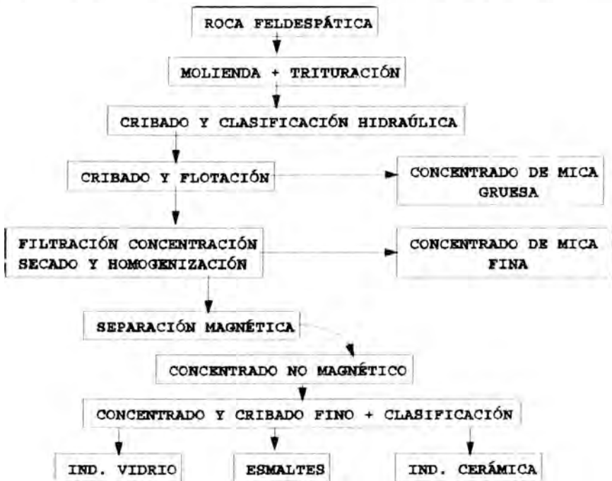
Fig 3. Circuito de purificación-enriquecimiento de una roca feldespática,
