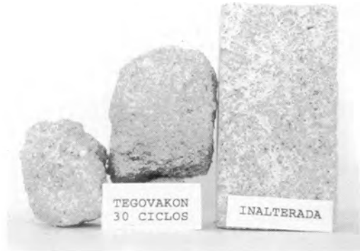
Fig. 7. Probeta de caliza tratada con Tegovakon, sometida a 30 ciclos de cristalización de sales, y probeta de referencia
