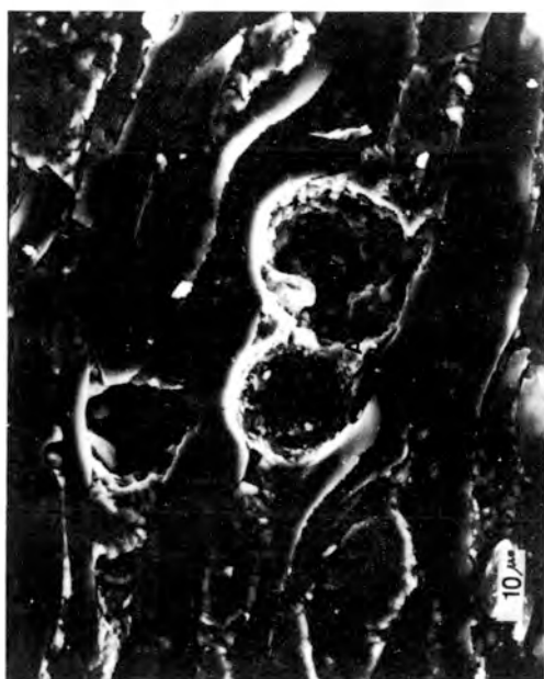
Foto 1. Cuerpo orgánico estructurado (fusinita) con las cavidades celulares rellenas de arcilla (A) (SEM).
