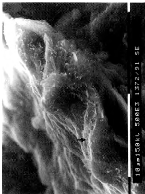
Figura 8: Agregados laminares de paligorskita en cuya superficie se observa la morfología fibrosa del mineral.
