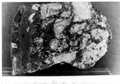
Fig. 5.- Banda milonítica desarrollada en galena, afectando a una estructura brechoide anterior. M: milonita.
