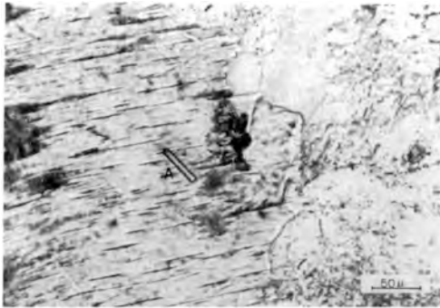
Fig. 3- Granodiorita. Cristal prismático de apatito (A) en biotita.
