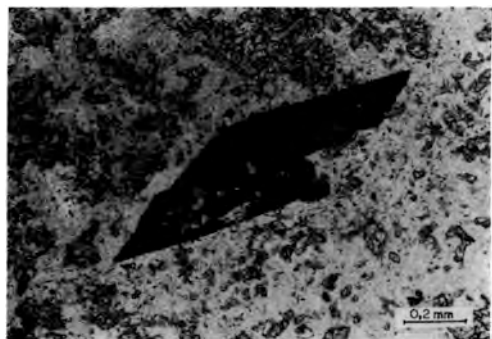
Fig. 9- Cristal automorfo de arsenopirita sustituyendo a componentes de la roca, en la zona de skarn.
