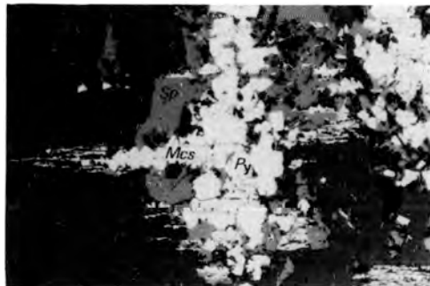
Fig. 8- Pirita y marcasita (P-3) reemplazando a esfalerita de la paragénesis P-2 y a cuarzo. Luz reflejada (x100). Py = pirita; Mcs = marcasita; Sp = esfalerita; Q = cuarzo.
