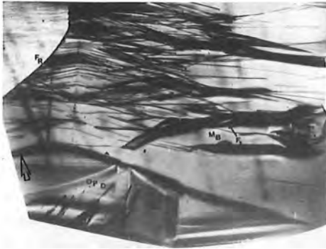
Fig. 13.- Topografía realizada sobre una lámina Y de un cristal de cuarzo sintético. Reflexión 3031. En ella se puede observar: a) La región maclada con la ley del Brasil M_B . b) Su frontera de dos tipos irregular y rectilínea, esta última paralela a (0111). c) Defectos planos D_2 asociados a la macla. d) Dislocaciones D dentro del sector X, que indican claramente una variación de la dirección de crecimiento. Es una perturbación del mismo ligada al desarrollo de la macla. e) Una fractura mecánica F_R originada durante la preparación de la lámina.
