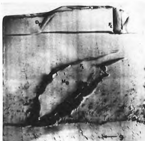
Fig. 16.— Topografía sobre una pequeña parte de una lámina Z de un cristal sintético maclado con la ley de Brasil. Reflexión 0110. En ella se observa como la región M_B maclada con la ley del Brasil se prolonga en el sector X en una estrecha lámina.
