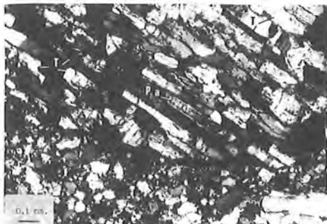
Fig. 5.- Corte tangencial del tejido vegetal, mostrando las traqueidas (T) y las puntuaciones aeroladas (P.a.). Es patente el crecimiento del megacuarzo controlado por la microestructura vegetal original. Nícoles cruzados.
