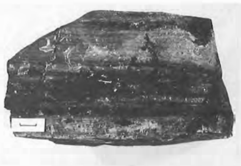
Fig. 5. Granates espesartíticos con inclusiones de turmalina y óxidos de Fe y/o Ti.
