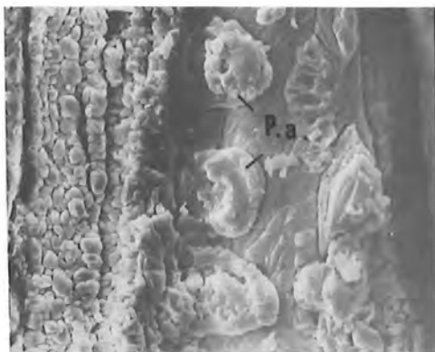
Fig. 6.- Microfotografía (SEM) en sección tangencial en que se muestran las puntuaciones aeroladas (P.a.) así como los megacuartzos tapizando las paredes de las traqueidas. X 700.
