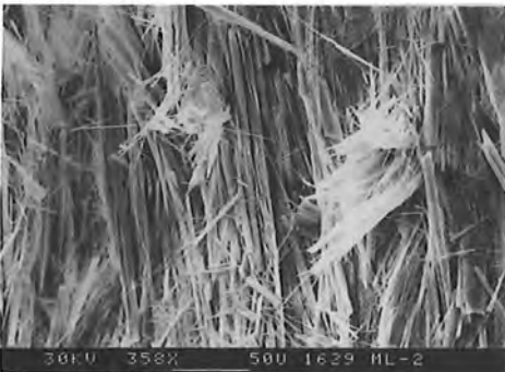
Fig. 4.- Aspecto del asbesto con morfología en masa. La línea equivale a 50µ (microscopio electrónico).
