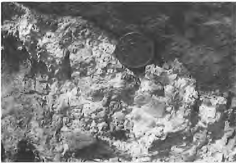
Fig. 2.- Detalle del filoncillo de asbesto relleno en un plano de fractura en la dolerita.
