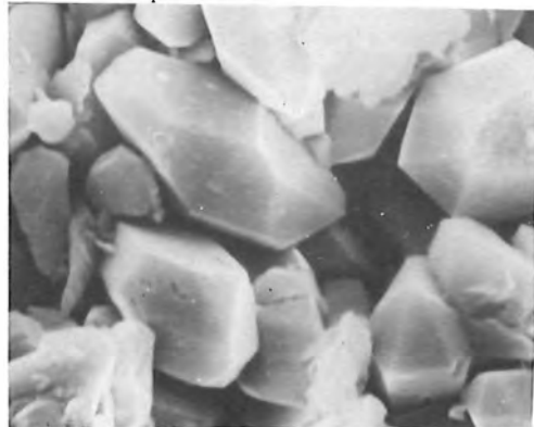
Fig. 7.- Microfotografía (SEM) en detalle de los megacuartzos de la fig. anterior. X 6.000.
