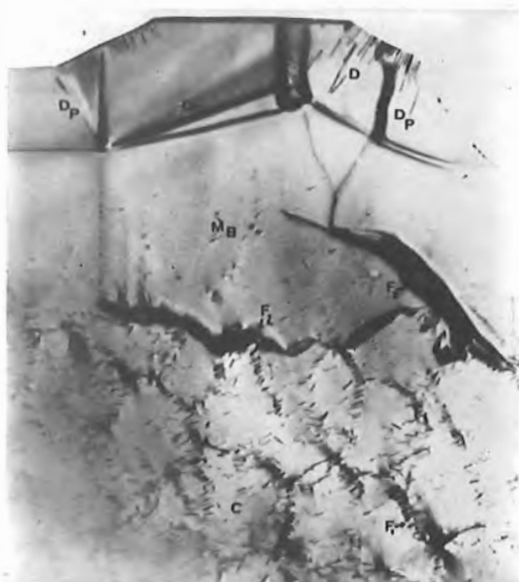
Fig. 8.- Topografía sobre una lámina Z. Reflexión 0331. En ella se observa: a) Una zona M_B maclada con la ley del Brasil, sus fronteras y sus defectos asociados. b) La distribución de las dislocaciones dentro del sector Z en células c, así como el contraste producido por las paredes F_1 de dichas células.
