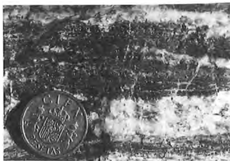
Fig. 7. Fluorita bandeada. Nótese la textura relicto (laminación) en las bandas oscuras (generación I).
