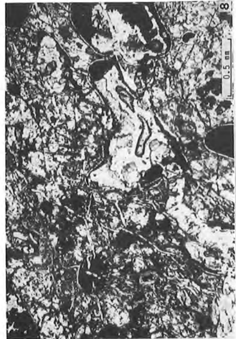
Nº 8. Aspecto general de una verita alterada y microfisurada, con abundantes cavidades ocupadas por jarosita, óxidos de hierro, calcita y sílice microcristalina. Luz transmitida, un polarizador.
