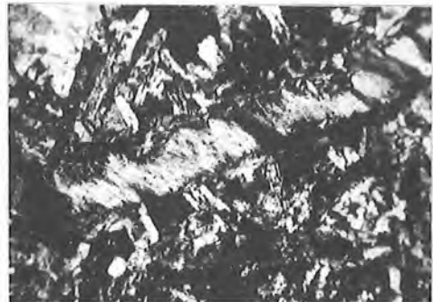
Fig. 3.- Detalle microscópico de una fractura de dolerita transformada con anfíbol + cuarzo + albita (luz transmitida) NP 150 X.
