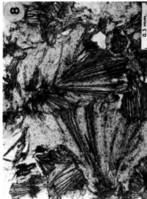
Fig. 8.— Crecimientos cono-radiales y palmados de tirolita. Entre esos haces hay pequeños cristales aciculares de lavendulanita. Minas de Molvizar. Luz paralela.
