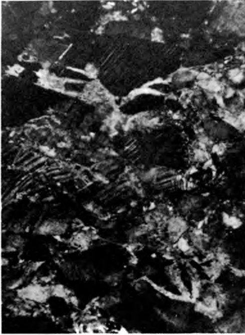
Fig. 6.— Muestra 4/3. Cristales de baritina muy deformados con fenómenos de cataclasis y desarrollo de maclas mecánicas. Relleno de calcita en planos de fracturas.
