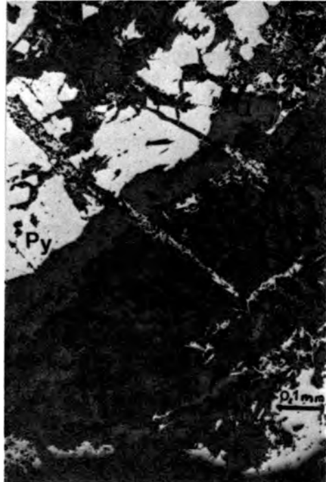
4.- Esfalerita removilizada en vetas que cortan a Cuarzo (Q) y Pirita (Py) previamente removilizados.
