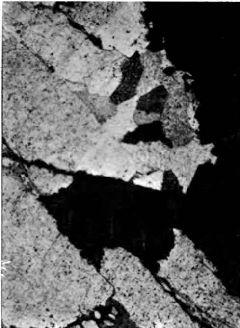
Fig. 8.— Muestra 1/1. Reemplazamiento de baritina por carbonato.
