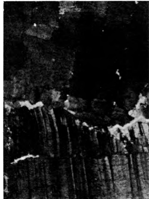
Fig. 9.— Muestra 2/1. Cristales de baritina algo deformados, mostrando desarrollo de maclas mecánicas que deforman a su vez a las maclas polisintéticas. Se observa además una cristalización posterior de cristales subidiomorfos de carbonatos relleno huecos y reemplazando parcialmente a la baritina.
