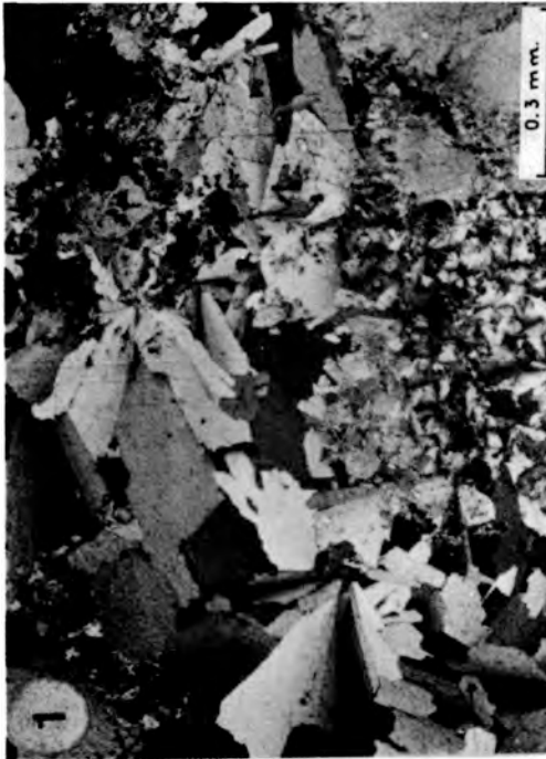
Fig. 1.— Cristales fibroso-radiados y tabulares de hemimorfita, relleno de una diaclasa en dolomías. Minas del Cerrajón, Sierra Nevada. Polarizadores cruzados.
