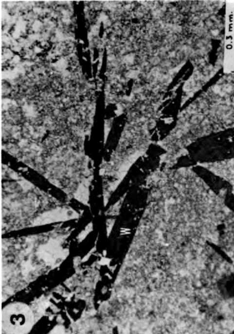
Fig. 3.— Cristales discoidales y tabulares de wulfenita (gris oscuro) en una dolomía brechoide. Minas del Madroñal (Quéntar). Luz paralela.
