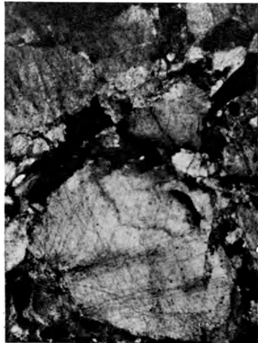
Fig. 7.— Muestra 4/3. Aspecto textural de cristales de baritina mostrando desarrollo de exfoliación y deformación intergranular que determina una extinción ondulante.
