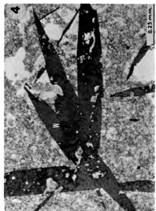
Fig. 4.— Detalle de la muestra anterior. Los cristales de wulfenita están parcialmente disueltos. Luz paralela.
