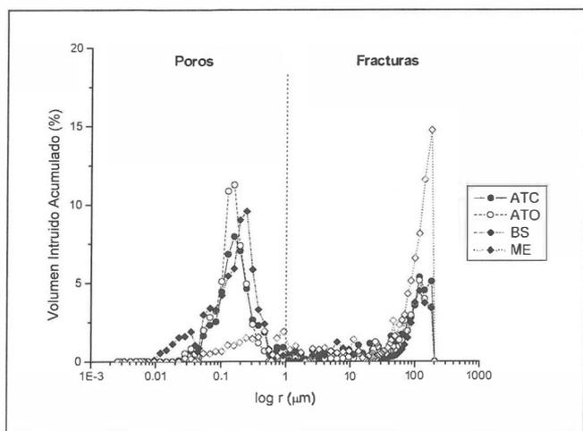
Figura 1: Curva de distribución de tamaños de poros obtenida con porosimetría de mercurio mostrando los dos tipos de poros: matriz y/o cemento ( $0.01 - 1 \mu\text{m}$ ) y fracturas o fisuras ( $r > 1 \mu\text{m}$ ).
