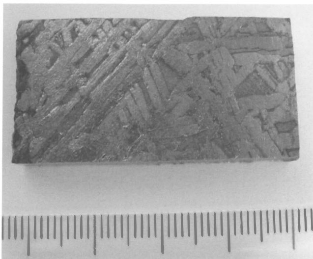
Figura 1: Una de las secciones del fragmento del siderito de Toluca utilizada en este estudio. Obsérvese el patrón textural del Widmanstätten.
