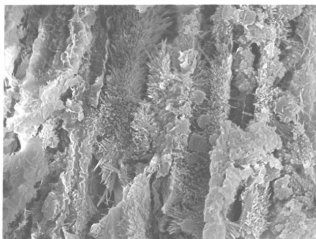
Figura 6: Fibras de mordenita. Electrones secundarios en microscopía electrónica de barrido.
