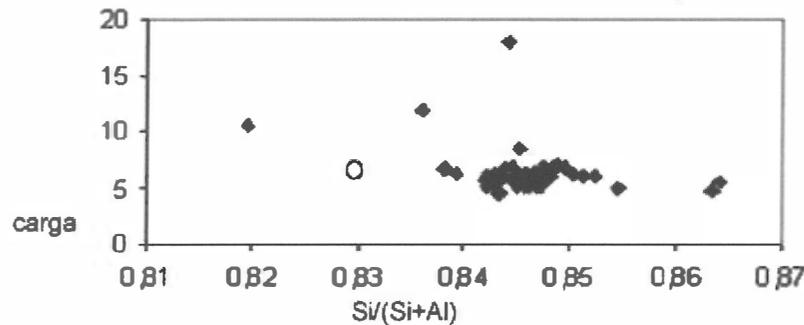
Figura 4: Valores de R (= Si/(Si+Al)) vs. carga de cationes cambiabiles correspondientes a los análisis puntuales. El círculo representa la mordenita teórica.
