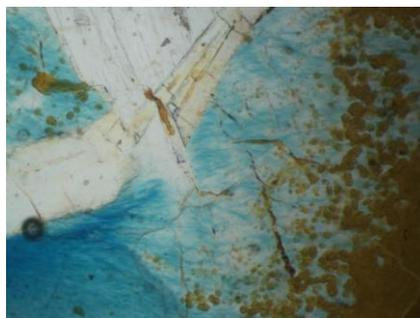
**fig 3.** Detalle de una de las zonas medidas de la lámina delgada, donde se observa el mineral identificado como cabasita relleno de fibras de aerinita.
