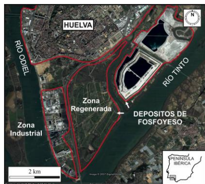
fig 1. Balsas de fosfoyesos localizadas en Huelva. El Océano Atlántico está a 10 km al Sur. Zona regenerada: cubierta de suelo de 30 cm con vegetación sobre la superficie del fosfoyeso.
