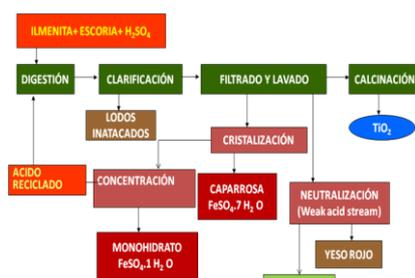
fig 1. Esquema del proceso industrial de obtención de  $\text{TiO}_2$ .
