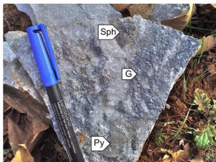
fig 2. Mineralización de sulfuros ligada a rocas carbonatadas (Py: pirita; G: galena; Sph: esfalerita).
