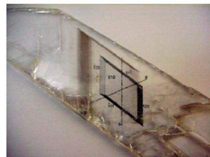
fig 1. Morfología tabular del yeso dibujada por inclusiones sólidas en un cristal selenítico de Segóbriga. Este cristal desarrolla las formas clásicas del yeso,  $\{010\}$ ,  $\{120\}$  y  $\{-111\}$ .
