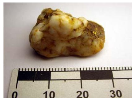
fig 2. Fragmento de filón de cuarzo con oro y óxidos de hierro (escala en milímetros).
