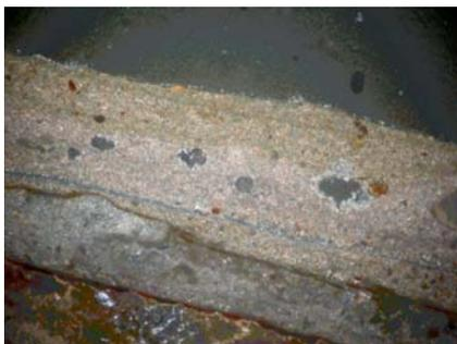
fig 3. Microfotografía del mortero de enlucido mostrando las tres capas que lo forman. 1 cm.= 1,5 mm.
