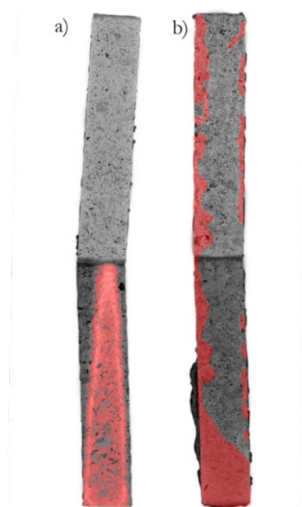
Fig 1. Imágenes de tomografía de rayos X tomadas tras el ensayo de capilaridad de probetas de calcarenita de Santa Pudía 3x3x30 cm, por la altura de la muestra la tomografía se hizo en dos secciones. a) Probeta con carbonato potásico b) Probeta con carbonato de sodio.
