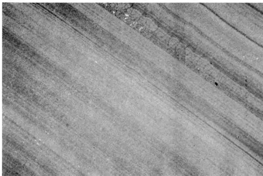
Fig. 7.— Malaquita, en finas bandas concéntricas. Luz transmitida, polarizadores cruzados y filtro verde, 27X.
