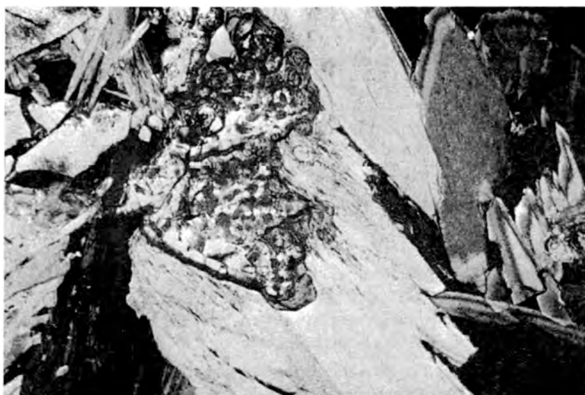
Fig. 6.— Cristales de atacamita con varios hábitos y orientaciones. En el centro, cristales globulares de crisocola. Luz transmitida, polarizadores cruzados, 27x.
