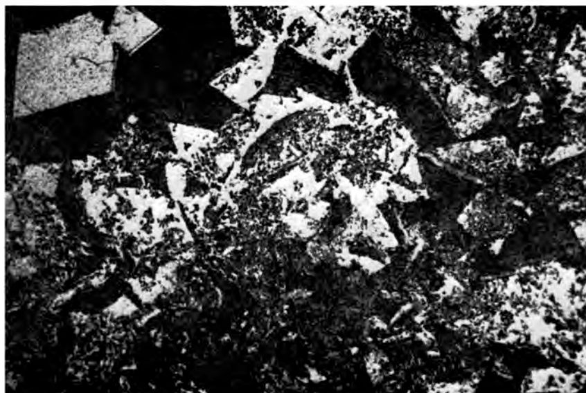
Fig. 6.— Cristales de azurita, algunos de contorno romboédrico, con abundantes intersticios, rellenos incipientemente por calcita. Luz transmitida, polarizadores cruzados, 27x.
