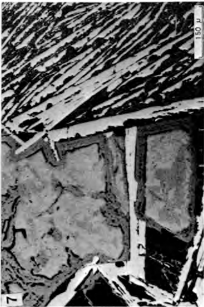
Foto 7.— Cristales prismáticos y aciculares de hematites englobando a dos cristales anteriores de pirita limonitizada. Luz reflejada, un polarizador.
