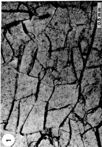
Foto 1.— Zona marginal de una escoria metálica en la que se observa el agrietamiento producido durante el enfriamiento del fundido. Luz transmitida, un polarizador (espesor de la lámina, 20 micras).
