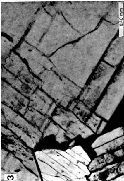
Foto 3.— Celestina. Secciones paralelas a (001) y (110). Luz transmitida, polarizadores cruzados.
