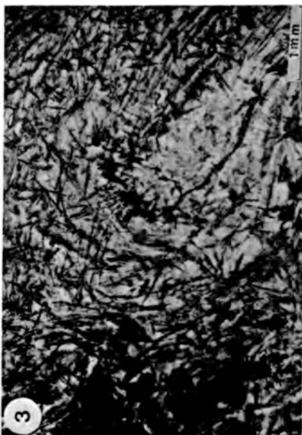
Foto 3.— Intercrecimientos de tenorita, cuprita y masicot en el seno de un fundido metálico. Luz transmitida un polarizador.
