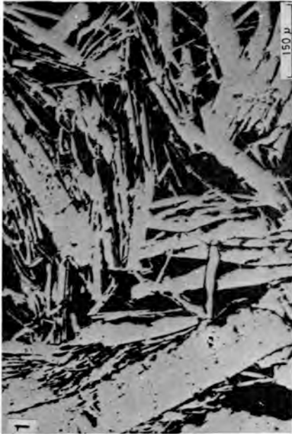
Foto 1.— Hematites especular en cristales prismáticos y aciculares formando un entramado poroso. Luz reflejada, un polarizador.
