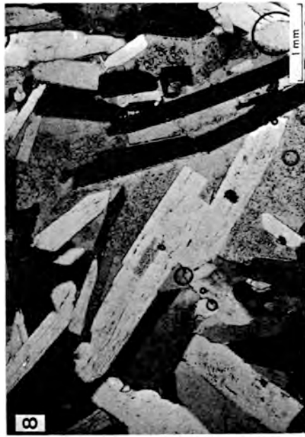
Foto 8.— Celestina prismática en haces de cristales con diferente orientación. Luz transmitida, polarizadores cruzados.
