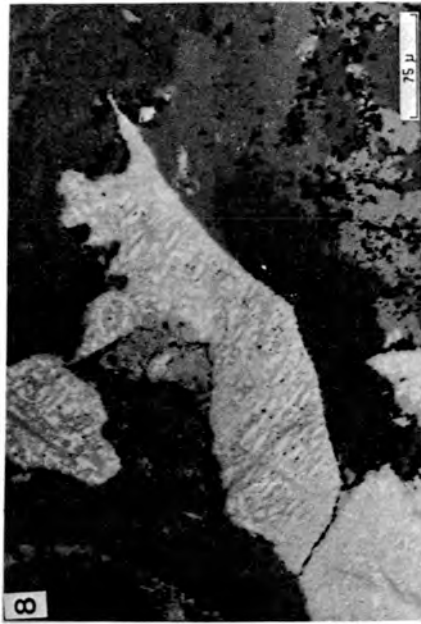
Foto 8.— Intercrecimiento de magnetita e ilmenita en una metabasita mineralizada. Luz reflejada, un polarizador.
