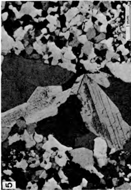
Foto 5.— Relleno de celestina en una fisura; se observan dos generaciones de cristales, una de grano fino y otra prismática en el centro, más moderna. Luz transmitida, polarizadores cruzados.
