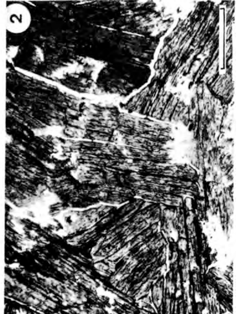
2.- Cristales prismáticos de roselita, con exfoliación (010) perfecta. Un polarizador, con diafragma semicerrado. Tamaño de la escala = 0.4 mm.
