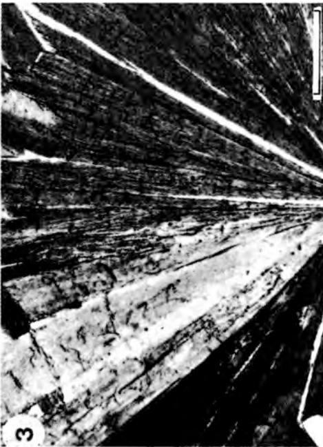
3. Roselita en haces de cristales radiados, con exfoliación muy marcada. El contraste de tonalidad de los cristales es consecuencia del pleocroísmo. Un polarizador, con diafragma algo cerrado. Tamaño de la escala = 0.3 mm.
