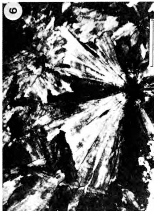
6.- Crecimiento radial de roselita, con eritrina, anabergita y dolomita. Polarizadores cruzados (destaca la extinción recta en esta orientación). Tamaño de la escala = 1 mm.
