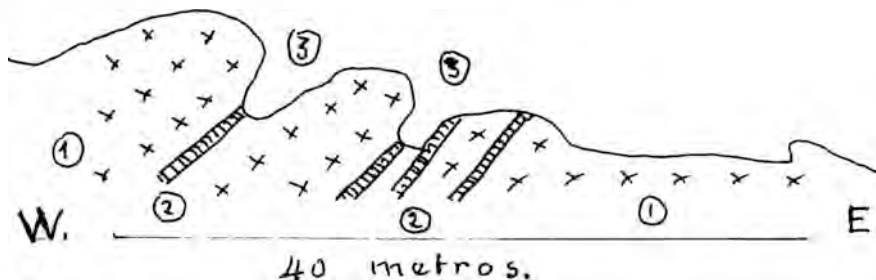
Fig. 3.— La Planta — 1 granitos — 2 filones metalizados de estaño y wolfram — 3 zanjas de trabajos en cabeza de filón — Rumbo de los filones N. 39°E buzamiento NW.
