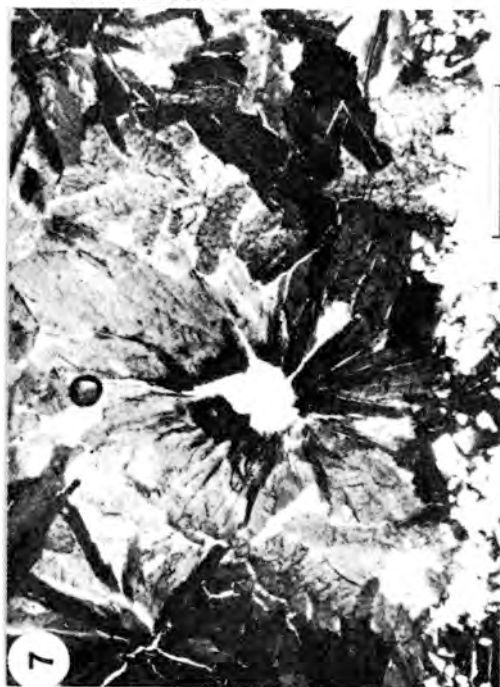
7.- Crecimiento conjunto de roselita y simplesita (hacia el centro de la foto, gris muy oscuro a negro). En la parte inferior se observan cristales de dolomita (blancos). Un polarizador. Tamaño de la escala = 1 mm.
