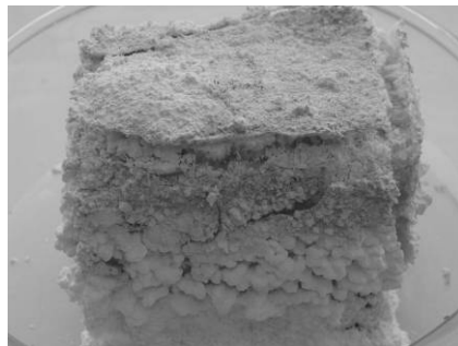
fig 2. Aspecto de una pieza compuesta por calcarenita más mortero tras el ensayo de eflorescencia salina. Los cristales aciculares de sal originan y desplazan escamas de calcarenita.
