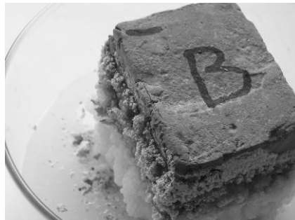
fig 1. Aspecto de una pieza compuesta por ladrillo más mortero con aireante tras el ensayo de eflorescencia salina.
