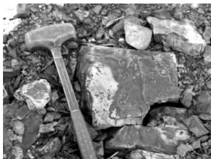
fig. 2. Costra de schuetteita (clara) reemplazada por costras de jarosita (tono gris intermedio). Las zonas más oscuras, situadas cerca de microfrazas de la muestra, no tienen costras de meteorización. Escombrera de El Entredicho.
