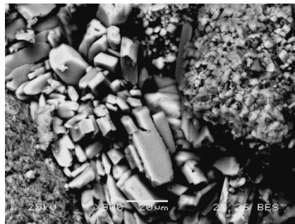
fig 5. Sales de carbonato de K creciente bajo la capa de tratamiento (SEM).
