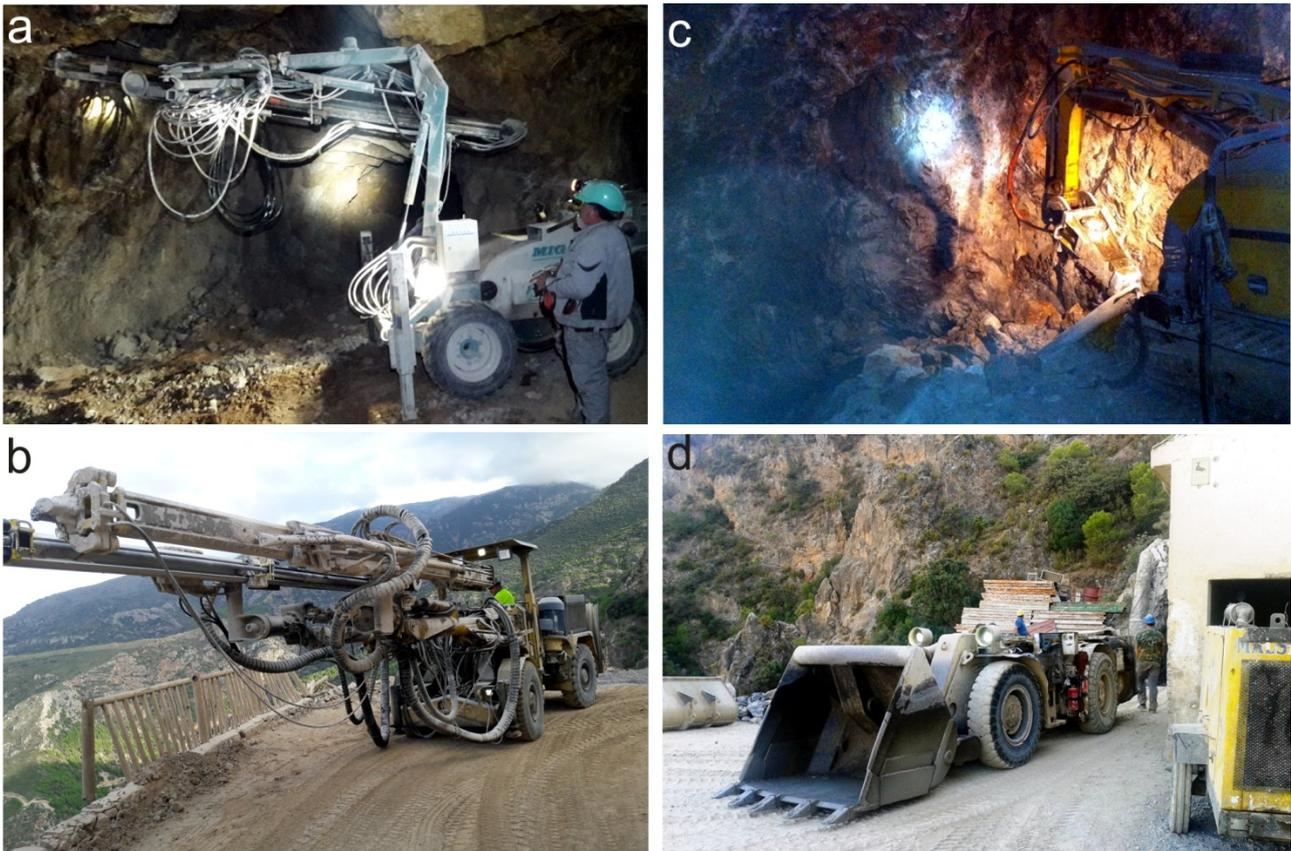
**Fig. 10.** Ejemplo de máquinas empleadas en la Mina Lijar. a) Perforadora de un brazo. b) Perforadora de dos brazos tipo Jumbo. c) Robot de demolición teledirigido. d) Pala cargadora de perfil bajo (LHD).
