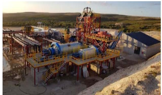
**Fig 5.** Área de clasificación y molienda de la planta de procesamiento de la mina de Penouta.
