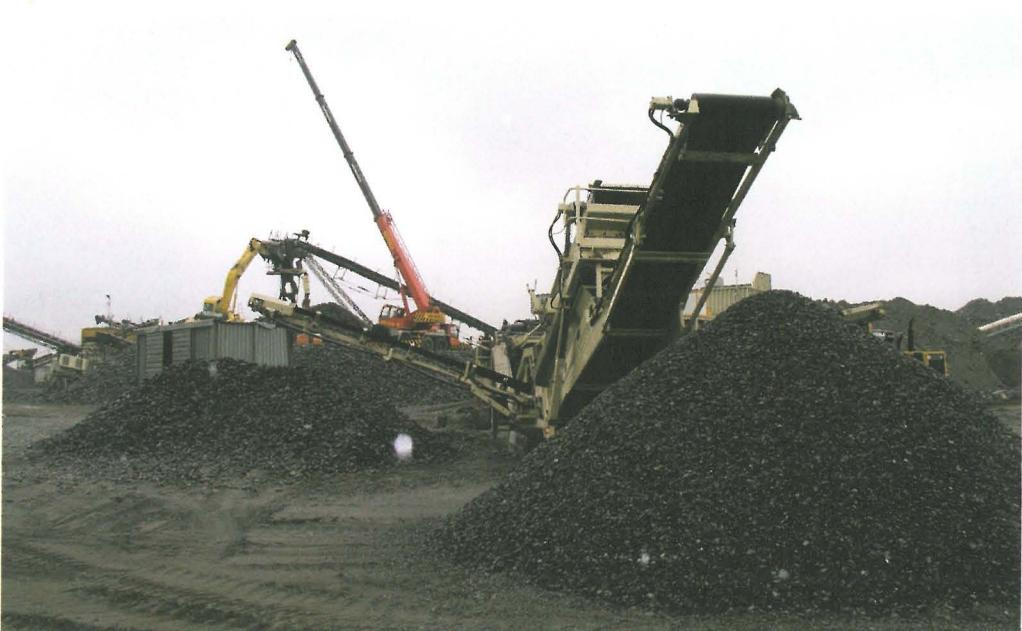
FIGURA 7. Planta móvil de trituración y cribado de áridos con destino a las obras de infraestructura del AVE en Almonacid de Toledo (Áridos Arnó).
