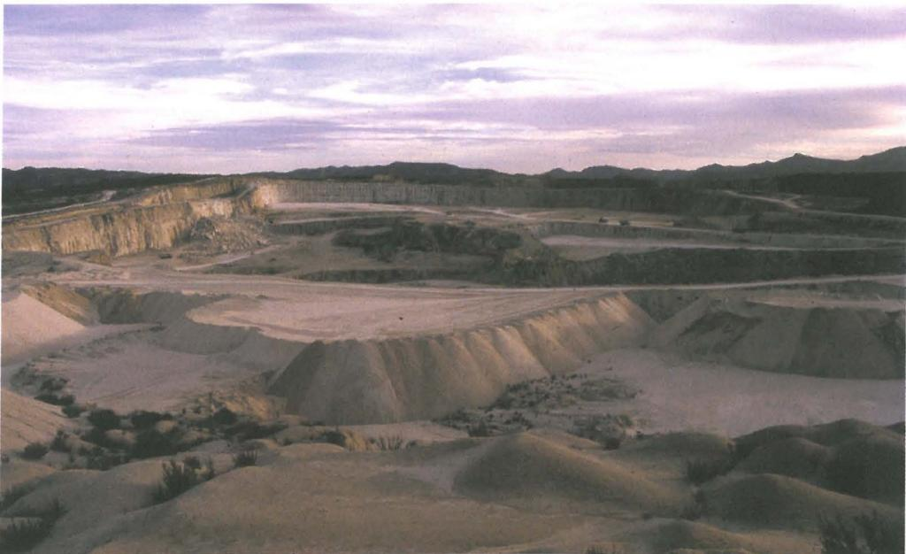
FIGURA 10. *Explotación de yesos de edad Messiniense en Sorbas, provincia de Almería. En esta explotación, la mayor parte del yeso se comercializa en crudo, siendo directamente embarcado para su exportación en el vecino puerto de Carboneras.*
