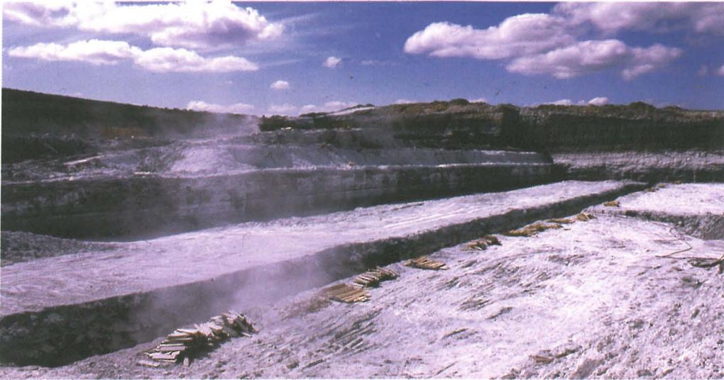
FIGURA 12. Explotación de glauberita en Cerezo de Río Tirón, provincia de Burgos. La extracción se realiza mediante voladuras que esponjan el material, el cual es posteriormente lixiviado haciendo circular agua a la temperatura adecuada para la disolución incongruente del sulfato sódico.
