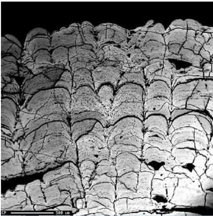
Fig 3. Estructura interna de una costra de Fe-Mn con texturas laminar y columnar y con alto contenido en cobalto. Fotomicrografía EPMA.
