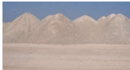
Fig. 1. Acoplo de AGR fracción 0-25 mm para uso en zahorra.
