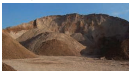
Fig. 1. Acoplo de AGR fracción 0-40 mm para uso en relleno de terraplén.
