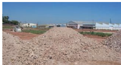
Fig. 2. Acoplo de AGR fracción 0-100 mm para uso en relleno de terraplén.
