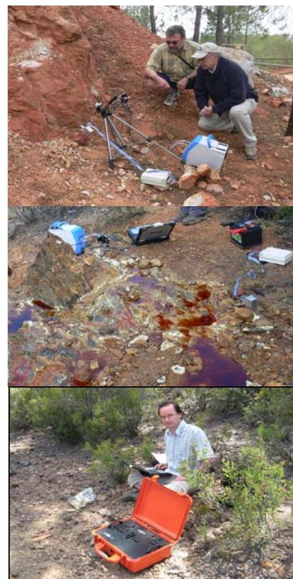
Fig 1. De arriba abajo: Prototipos portátiles de Raman y Mössbauer (MIMOSII, Klingerhoefer et al. 2003) y de DRX (TERRA inXitu inc.) adquiriendo espectros in-situ en Rio Tinto.
