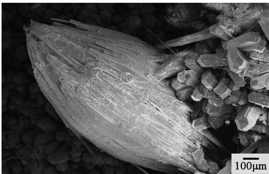
Fig. 1. Agregado fusiforme de cristales de ettringita, asociado a cristales de phillipsita-Ca. Cantera de La Herrería. Fotografía de microscopio electrónico de barrido (electrones secundarios).
