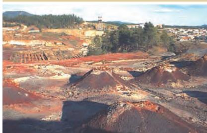
fig 2. Antigua plaza de calcinación, donde aún se conservan algunos montones de pirita tostada al aire libre y restos de los canales de cementación.
