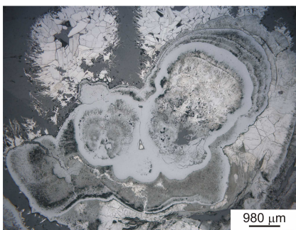
Fig. 1 Aspecto general de los botroides de romanechita y de los cristales tabulares de pirolusita. Imagen de luz reflejada con nicolo paralelos.
