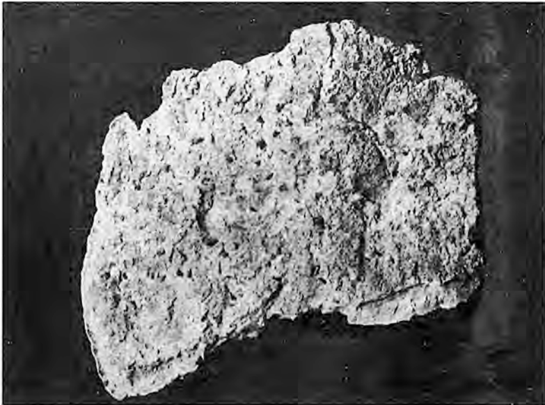
Fig. 86.—Cristales de dolomita (teruelita) implantados en el yeso de Teruel ( \frac{1}{2} del tam. nat.)
