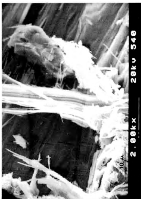
Figura 6.- Detalle de las fibras de la tremolita asbestiforme.
