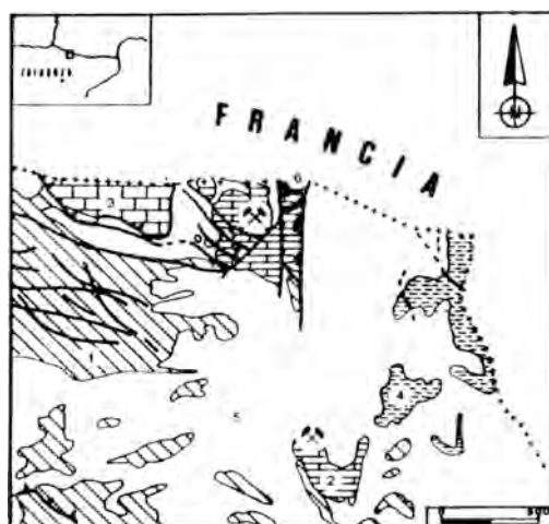
Figura 1. Situación geológica de las minas de Fluorita del Portalet. Devónico inferior: 1=fc. Formigal; Carbonífero: 2=Tournasiense-Viseense, 3=Namuriense, 4=Westfaliense; Cuaternario: 5; Andesitas: 6. (Bixel et al. (1985) modificado).
