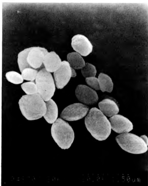
Fig. 4: a) Micrografía de partículas de variscita (sistema 3, \text{pH}_0:1.8 ) b) Micrografía de berlinita (sistema 6).
