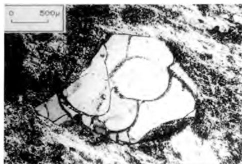
Fig. 10.- Cristal análogo al de la fig. 9, con los fragmentos algo más separados y las cavidades entre los fragmentos rellenos por la mesostasa vítrea. Lámina delgada, nícoles cruzados.
