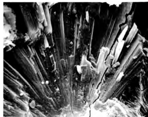
Fig. 6. Vidrio alterado en abanico (x2000)
