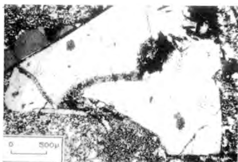
Fig. 11.- Cristal de cuarzo fragmentado y subdividido en otros, de bordes bastante angulosos e irregulares. Aún resulta posible recomponer la antigua morfología del cristal, aparentemente de carácter idiomorfo. La pasta de fondo existente entre los diferentes fragmentos es microcristalina, de un tamaño ligeramente mayor al de la mesostasa, y suele ser más sericitica que ésta y/o contener pátinas y/o cristales de óxidos de Fe. Lámina delgada, luz paralela.
