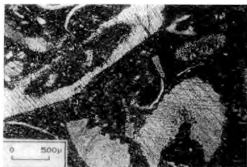
Fig. n. 2.- Wackestone en el que resaltan grandes placas monocristalinas de calcita correspondientes a fragmentos de pelmatozoos muy bien preservados. Lámina delgada, luz paralela.
