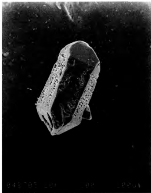
Fig. 4: a) Micrografía de partículas de variscita (sistema 3, \text{pH}_0:1.8 ) b) Micrografía de berlinita (sistema 6).
