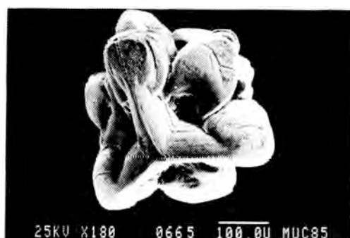
Fig. 6: Detalle de una vértice secundario del cristal de la figura 3. (MEB). Siguiendo estado evolutivo a la morfología de cristal en tolva. (MEB).
