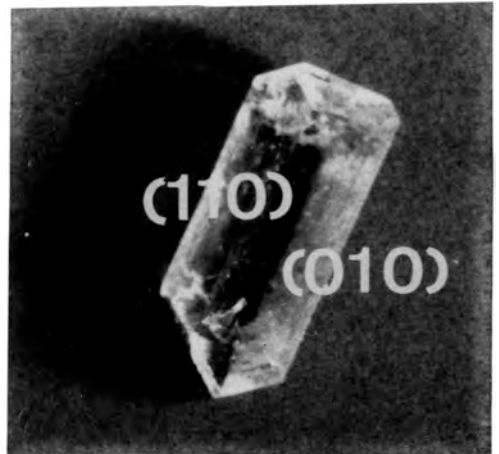
Foto 2.- Cristal de Epsomita crecido a 45°C. Presenta un importante desarrollo relativo a las caras con carácter F más débil ((010)), así como una relación L/A baja.
