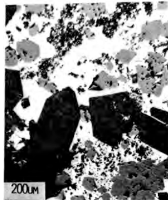
Figura 5. Cristales de hábito cúbico de pirita, con algún grano mixto pirita-esfalerita (gris claro).
