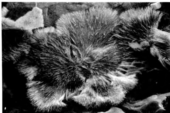
Figura 3. Zeolitas fibrosas. Mortero n.º 7. Edad: 365 días. Curado: Solución alcalina.
