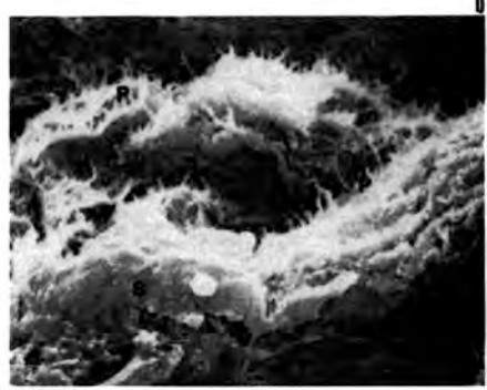
b) Aspecto detallado de láminas de esmectita (S) en las que se observan claramente crecimientos de fibras de paligorskita (P) en sus bordes. PU-6 (x 5000) (M.E.B.).
