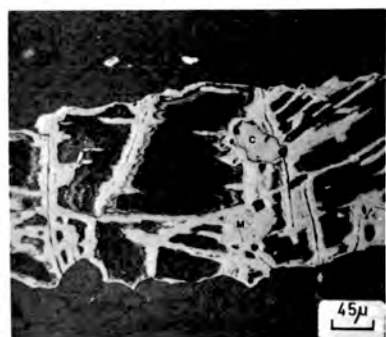
Figura 6. Reemplazo total de la pirrotina, por la marcasita (M) dando la textura en «rejilla». (C = grano de calcopirita sustituyendo a la pirrotina.)
