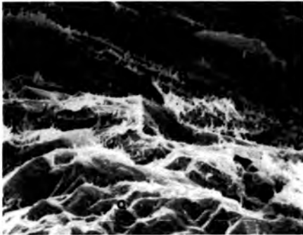
c) Detalle de cristal de cuarzo (Q) con fenómenos de disolución y láminas de esmectita (S) con crecimientos de paligorskita (P). PU-6 (x 5000) (M.E.B.).
