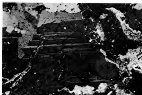
Figura 5. Borunonita con maclado «en parquet» (L.P. 85x).
