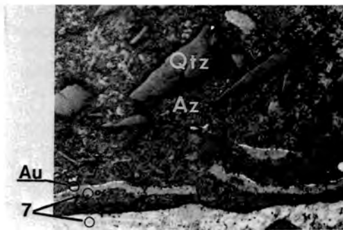
Figura 4. Detalle del pigmento azul (capa 7, 8 y 9 de la Fig. 3) mostrando varias láminas de oro (Au) debajo de una mezcla gruesa de cristales de cuarzo (Qtz) y azurita (Az). Iluminación oblicua, X200.
