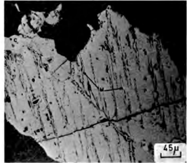
Figura 2. Mismo proceso de alteración en «bird's eyes» que en la figura 1 con bandas de marcasita (M) y de marcasita (M) más pirita (Py). (C = grano de calcopirita sustituyendo a la pirrotina (P).)
